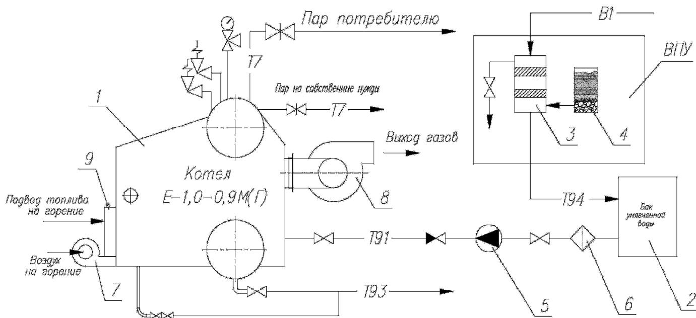
1. Котел Е-1,0-0,9М(Г); 2. Бак умягченной воды; 3. Фильтр катионитный; 4. Бак регенерационного раствора; 5. Питательный насос; 6. Фильтр-грязевик сетчатый; 7. Дутьевой вентилятор; 8. Дымосос; 9. Горелочное устройство.
